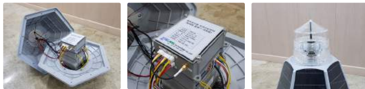
내장형 RTU가 전원일체형 등명기 내부에 장착된 모습
